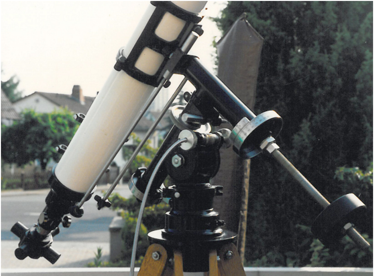
Abb. 13: Teilansicht des 100 / 1500 mm Unitron Refraktor (Modell Nr. 4732) mit großer parallaktischer Montierung. Quelle: Foto Remmert.
