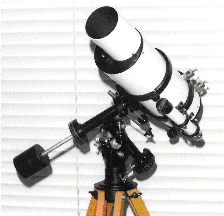
Abb. 07: Unitron – Kompakt Fernrohr 75/1200mm in Schaer Bauweise auf parallaktischer Montierung und Holzstativ. Quelle Archiv Remmert.
