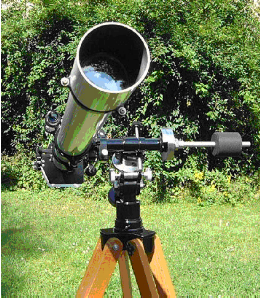
Abb. 01: 75/1200mm Unitron Refraktor mit parallaktischer Montierung und Dreibeinstativ, Quelle: Jürgen Kost ( www.meridiankreis.de )
