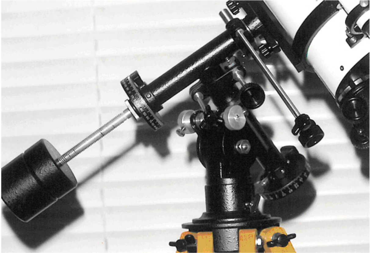
Abb. 09: Unitron – parallaktische Montierung, kleines Modell für Unitron 60mm Refraktor und das Compact Fernrohr.
